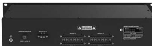
Мониторная панель серии MML служит для видео- и аудиоконтроля линий, имеет 6 или 12 восьмисегментных светодиодных индикаторов уровня для визуального контроля сигнала в линиях.
