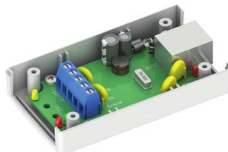
Блоки сопряжения с пожарной сигнализацией IFA-001, IFA-002, IFA-003 предназначены для интеграции пожарной сигнализации Болид, Рубеж, Юнитест и системы оповещения и управления эвакуацией «EMSOK» по интерфейсу RS-485, что позволяет исключить «сухой контакт», который требует установки двух дополнительных резисторов и множества линий связи (по два на каждое направление оповещения).
